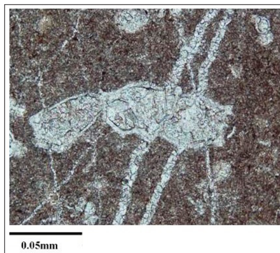
شکل ۷- رگه‌های کلسیتی در نمونه‌های بالای زون شماره ۹ و مرز کرتاسه پسین تا پالئوسن.
