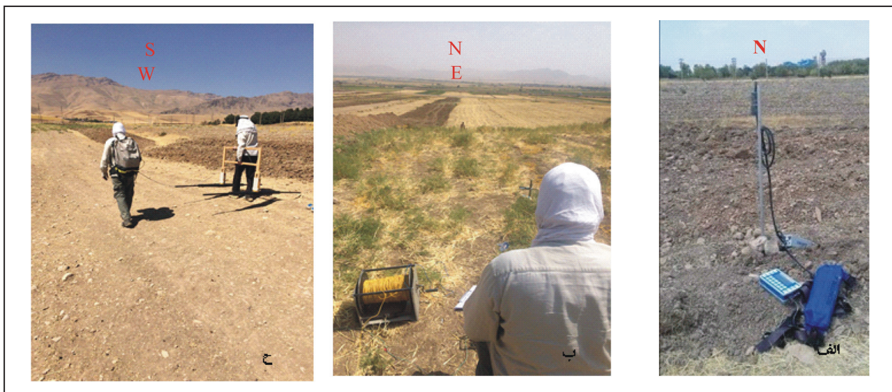
شکل ۴- سه روش ژئوفیزیکی استفاده شده: الف) مغناطیس‌سنج سزیم؛ ب) ژئوالکتریک RS؛ ج) رادار نفوذی GPR.
