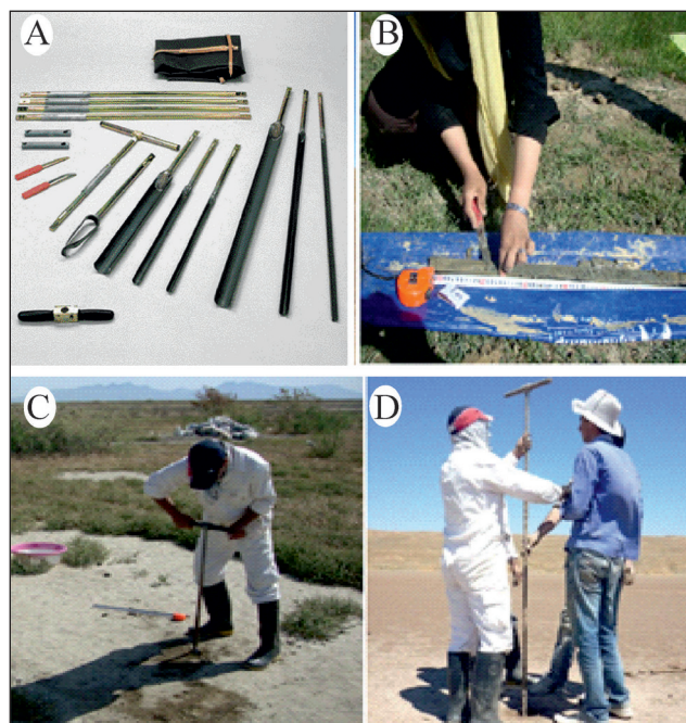
شکل ۲- (A) ادوات مغزه‌گیری، (B) برش، تفسیر و نمونه‌برداری، (C) و (D) نحوه مغزه‌گیری.
