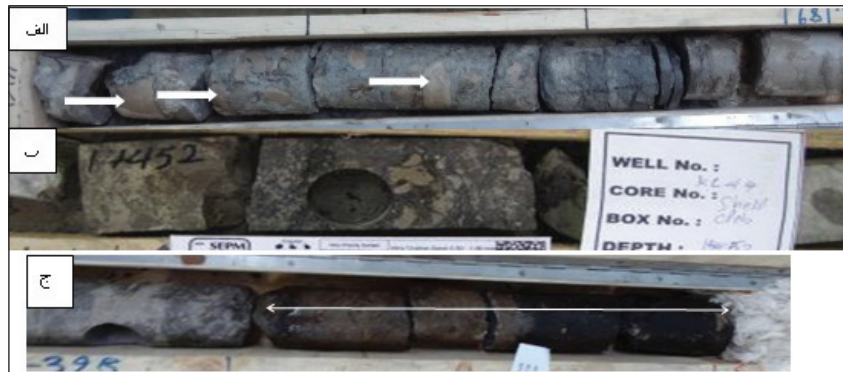
شکل ۵- الف) کارستی شدن و برش‌های انحلالی. فلش‌ها زمینه اصلی سنگ که در اثر ریزش به قلوه‌هایی تبدیل شده است، ب) برشی شدن؛ ج) آغشتگی به مواد هیدروکربنی.
