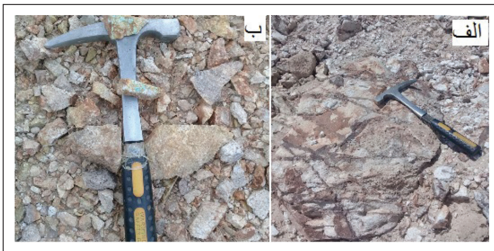
شکل ۱۷- الف) عکسی از استوک‌ورک‌ها در شمال شرق و شرق محدوده چاه‌سربی، اکسید شدن پیریت در رگچه‌ها باعث تیره شده است؛ ب) آثار کانی‌زایی مس (مالاکیت) در رخنمون‌های منطقه.
