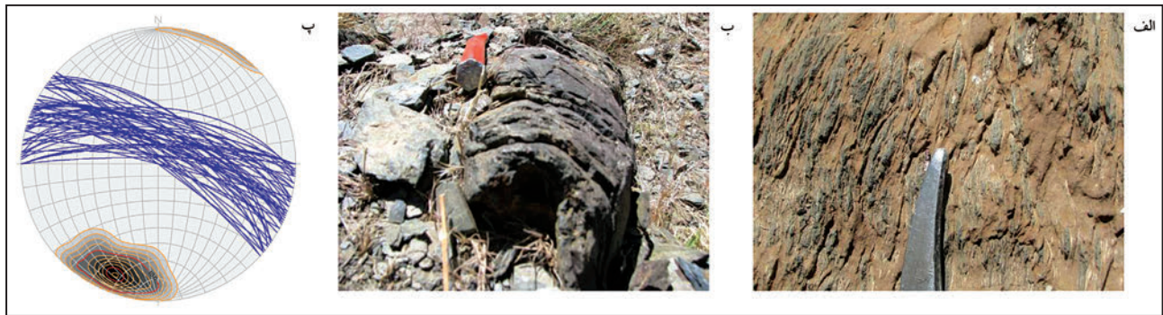
شکل ۳- چین‌خوردگی نسل دوم. الف) ترانهادگی لایه‌بندی در راستای برگوارگی S_1 در کرنات‌های دگرگون شده؛ ب) چین با لولای مدور در مرمر؛ پ) وضعیت سطح محوری به همراه وضعیت توزیع قطب این سطوح (تعداد برداشت=۶۵). برداشت این سطوح محوری به دلیل برونزد خوب در منطقه شرق بوین- میانداشت و از یال شمال خاوری طاق ریخت نوغان انجام شده است.
