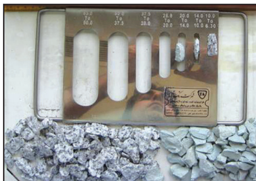
شکل ۶- ابزار تعیین ضریب تورق.
