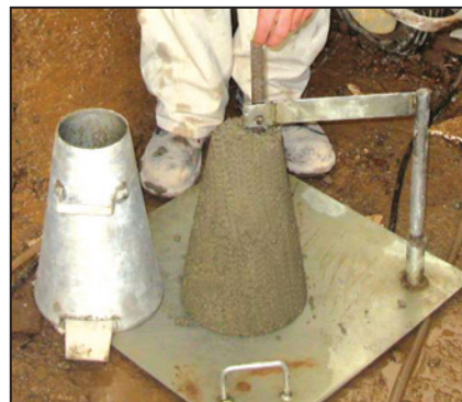
شکل ۱۲- انجام آزمایش اسلامپ.
