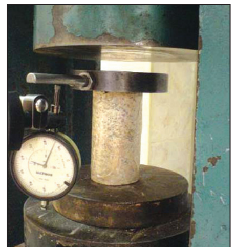
شکل ۱۱- انجام آزمایش مقاومت تک‌محوری سنگ مادر.
