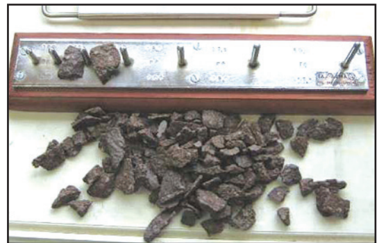
شکل ۷- ابزار تعیین ضریب تطویل.
