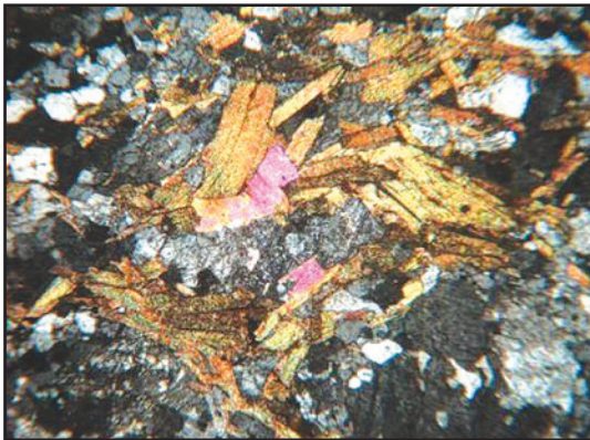
شکل ۲- تصویر میکروسکوپی گنایس با بزرگنمایی ۱۶ برابر.
