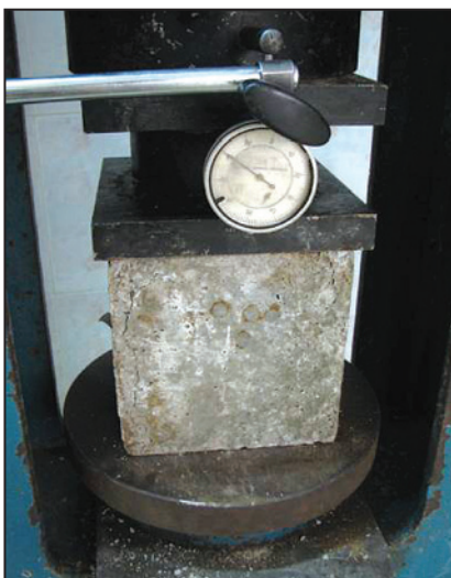
شکل ۱۳- انجام آزمایش مقاومت تک‌محوری فشاری بتن.
