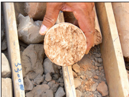
عکس ۸- گسل سنگ مربوط به گسل اهواز در ژرفای ۳۳ متری از گمانه نمایش داده شده در عکس ۷، در مرز آبرفت‌های جوان و سازند آغاچاری.
