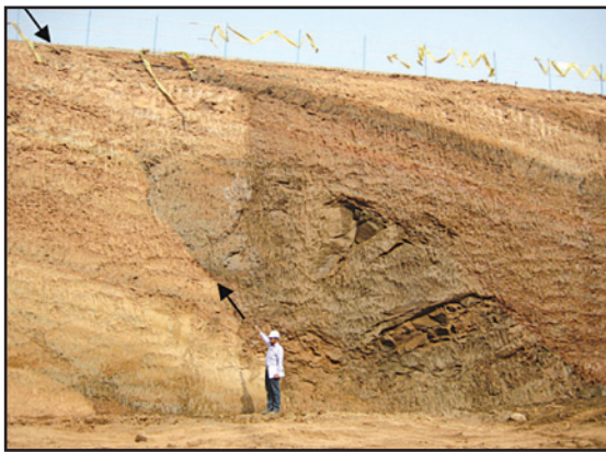
عکس ۴- نمایی از گسل مصلا در دیواره باختری ایستگاه مصلی، نگاه به سوی باختر.
