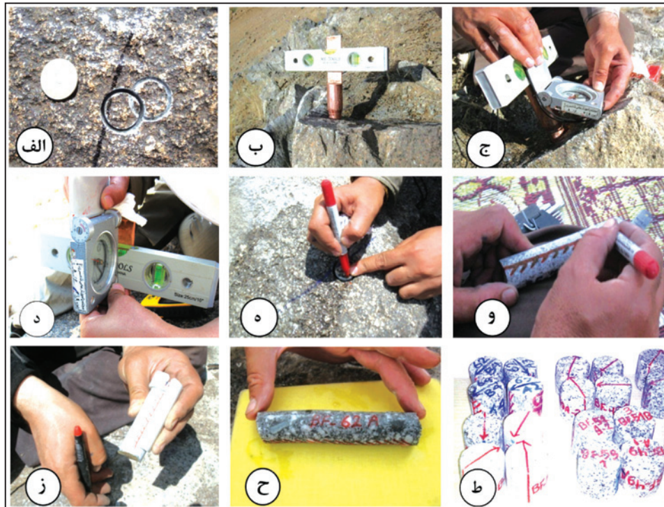
شکل ۱- تصاویری از مراحل مختلف برداشت نمونه (مغزه) برای مطالعات AMS و ریزساخت‌ها
