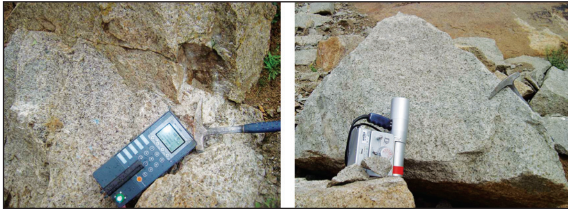
شکل ۵- برداشت‌های رادیومتری زمینی گرانیت‌های محدوده بی‌هنجاری عناصر پرتوزا با استفاده از سستیلومتر و طیف‌سنج در منطقه جنوب باختر ماسوله.
