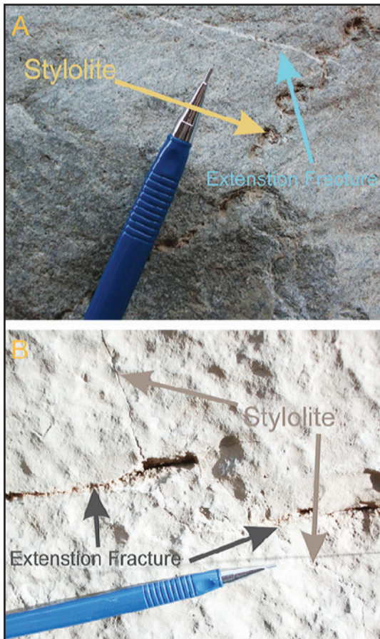
شکل ۷- وجود شکستگی‌های استیلولیتی شده که به صورت عمود بر لایه‌بندی تشکیل شده‌اند و راستایی عمود بر راستای شکستگی‌های کششی (شکستگی‌های پر شده با کلسیت) دارند.
