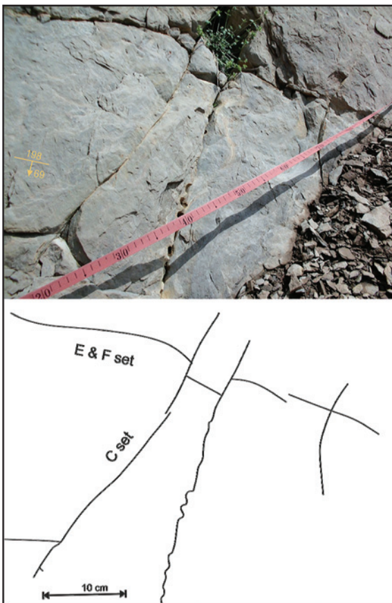
شکل ۵- وجود دو دسته از شکستگی‌های طولی (دسته C) و مورب (دسته E و F) در ایستگاه شماره ۵ که دارای لایه‌بندی با شیب ۶۹ درجه در جهت ۱۹۸ درجه است.
