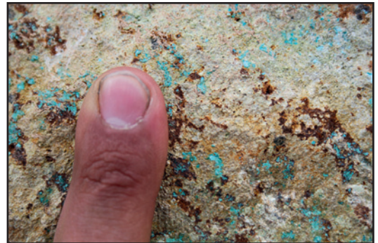
شکل ۷- ذرات مالاکیت در بخش‌های میانی کانسار، منطبق بر زون پتاسیک به همراه بیوتیت ثانویه و اکسیدهای آهن
