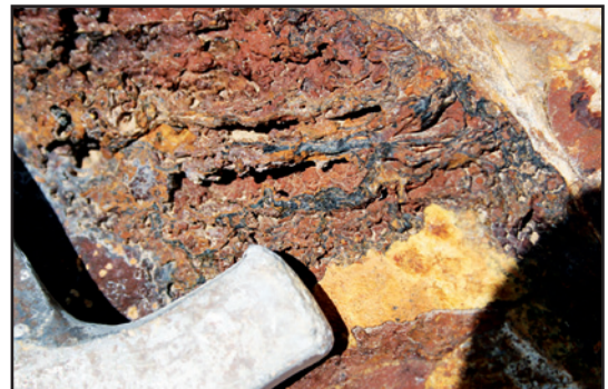
شکل ۵- نمونه‌ای از دگرسانی کانه‌های آهن‌دار و کوارتز- جاروسیت در باختر محدوده کانسار
