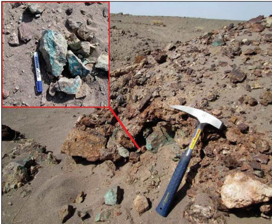
شکل ۲- نمایی از ترانشه حفر شده در بخش کانی‌سازی رگه‌ای که مالاکیت بر سطح سنگ‌ها به فراوانی دیده می‌شود (دید به جنوب باختری).
