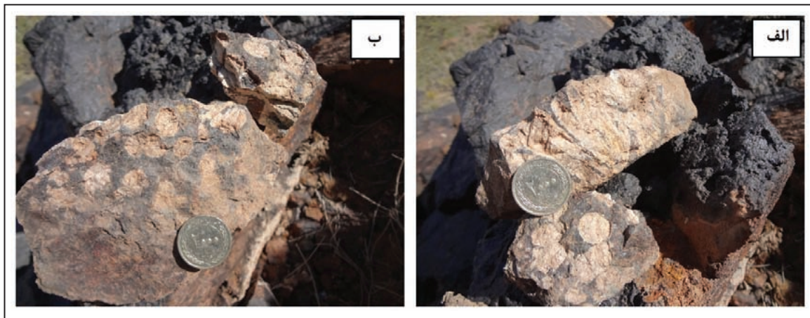
شکل ۵- نماهایی نزدیک از بلورهای خودشکل آپاتیت در متن کانسنگ مگنتیت در عدسی شماره ۲.
