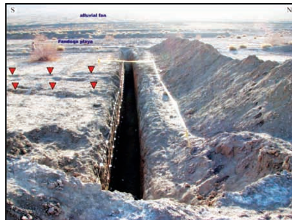
شکل ۱۱- نمایی از ترانشه شماره یک گسل گلباف. آثار گسیختگی‌های سطحی ناشی از زمین‌لرزه ۱۴ مارس ۱۹۹۸ با مثلث‌های سرخ نشان داده شده است.
