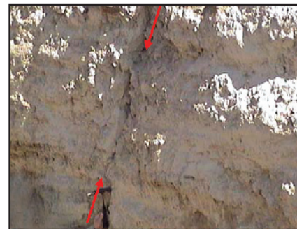
شکل ۹- اثر گسل (بین دو پیکان) در نهشته‌های کواترنری در ترانسه‌های حفر شده در شمال شهرک مهماندوست (مکان ۵ در شکل ۲) در مرز میان کوه و دشت در حریم گسل جنوبی در سوی خاور ورودی دره طزره (نگاه به سوی خاور).
