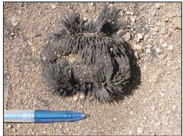
شکل ۱۴- تصویری از اجتماع دانه‌های ریز مگنتیت یا تیتانومگنتیت موجود در رسوبات آبراهه‌ای توده گرانیتیویدی چاه‌سالار که با آرایش زیبای متأثر از میدان مغناطیسی ایجاد شده در اطراف یک جفت آهن‌ریا، شاهد دیگری بر نوع I بودن این توده نفوذی است (محل خاور کلاته‌باغ).
