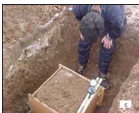
شکل ۱- تهیه بلوک خاک آزمایش: الف) حفر چاله شناسایی و تهیه بلوک دست نخورده، ب) تنظیم ابعاد بلوک و قطع ریشه‌های اضافی، ج) محیط کردن جعبه برش بر بلوک خاک و کنترل افقی بودن آن
