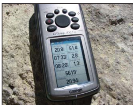
شکل ۱- اندازه‌گیری ارتفاع مخروط دماوند در قله با استفاده از GPS (عکس از زارعی‌نژاد، ۱۳۸۶/۷/۱۶)
