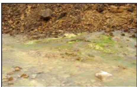
شکل ۵- زهاب اصلی دامپ ۲۶ (pH≈۵/۹)، کلوییدی شدن زهاب و انحلال سولفات‌ها، کاهش تراکم جلبک‌ها
