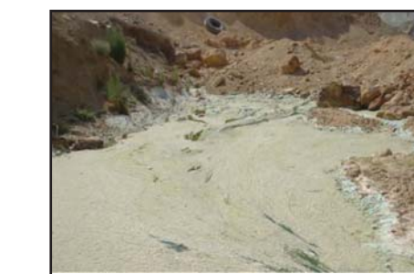
شکل ۳- زهاب دامپ ۱۱ در دوره کم آبی (pH≈۴/۵)، رسوب سولفات‌های مس و آهن
