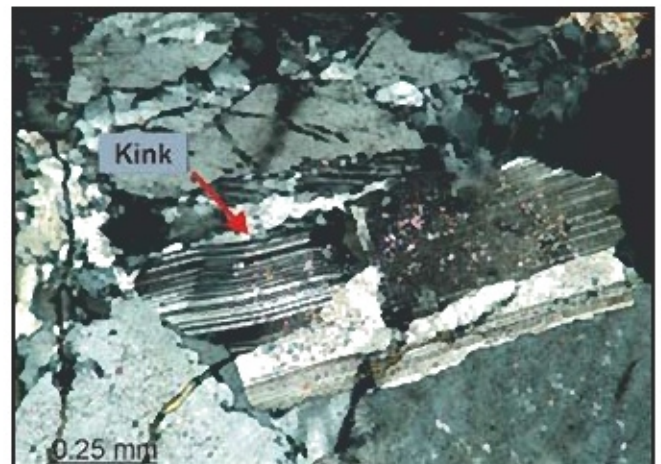
شکل ۶- پدیده همپوشی در ماکل رشد دانه‌های پلاژیوکلاز که ناشی از تنش حاکم بر منطقه است (PPL).
