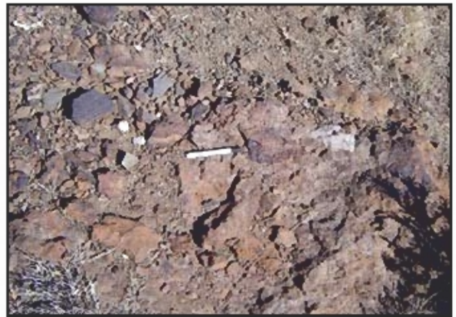
شکل ۳- زون مینرالیزه اکسیدی-حامل اکسیدهای آهن و منگنز و مالاکت، محدوده ده حسین.
