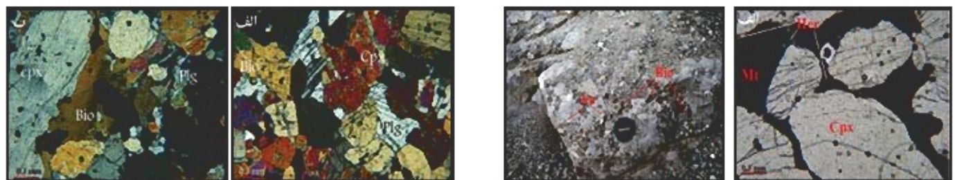
شکل ۵- الف) تصویر میکروسکوپی بلورهای کومولای کلیت پروگنیت در نوده و بلورهای ریزتر کومولوس مائیتت به صورت بی‌شکل (PPL). ب) تجزیه پروگنیت به ورده‌های درشت فلورگویت.
