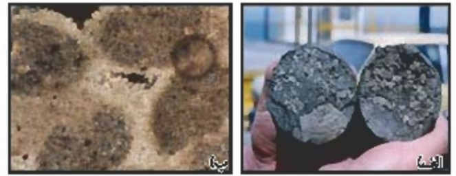
شکل ۷- وجود تشرهای کرتانی در اقل‌های خاص از مقزدها به صورت قطعه‌های اینتراکلاست. ب) تصویر میکروسکوپی از قطعه‌های پادشده که نشان از ماهیت کرتانه یا آثار تپور دوباره در حاشیه‌ها (سیمانی شدن) و انحلال پخش در مرکز را دارد (تور پلازیوم بزرگ‌نمایی ۴۰).
