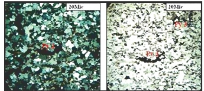
شکل ۲۵- تصویر بلورهای پیریت (Py) نسل سوم که در سری میولیتی شده، کشیدگی نشان می‌دهد و در این مورد به شکل شلیت (Scht) نسل ۱ (تور اپل) عبوری در سمت راست و تور اپل عبوری در سمت چپ، بزرگنمایی ۲۰x*10x*0.45، Oil
