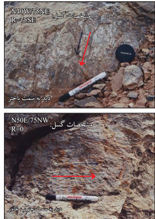
شکل ۳- سطوح گسله‌ها و خش لغزش‌های مربوط به آنها
