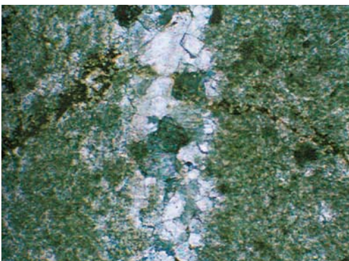
شکل ۴- دولومیت رگه‌ای با بزرگنمایی \times 25
