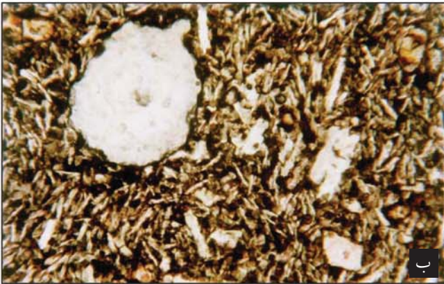
عکس ۷- خمیره میکرولیتی که تعدادی ریز بلورهای اولیون و کلینوپیروکسن و مقداری شیشه و اکسیدهای آهن (به رنگ سیاه در شکل ب) نیز وجود دارد. یک حفره تمیز و خالی در عکس دیده می‌شود. الف) با استفاده از تجزیه کننده (XPL) ب) بدون استفاده از تجزیه کننده (PPL)
