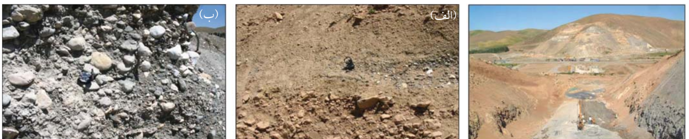
شکل ۴- تغییرات دانه‌بندی نهشته‌های آبرفتی ساختگاه: (الف) به سمت جناح چپ (ب) به سمت جناح راست
