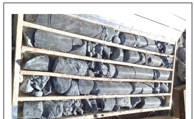
شکل ۲- مغزه‌های حفاری در معدن زرشوران که این داده‌های حفاری جهت محاسبه مقدار RQD استفاده می‌شود.
