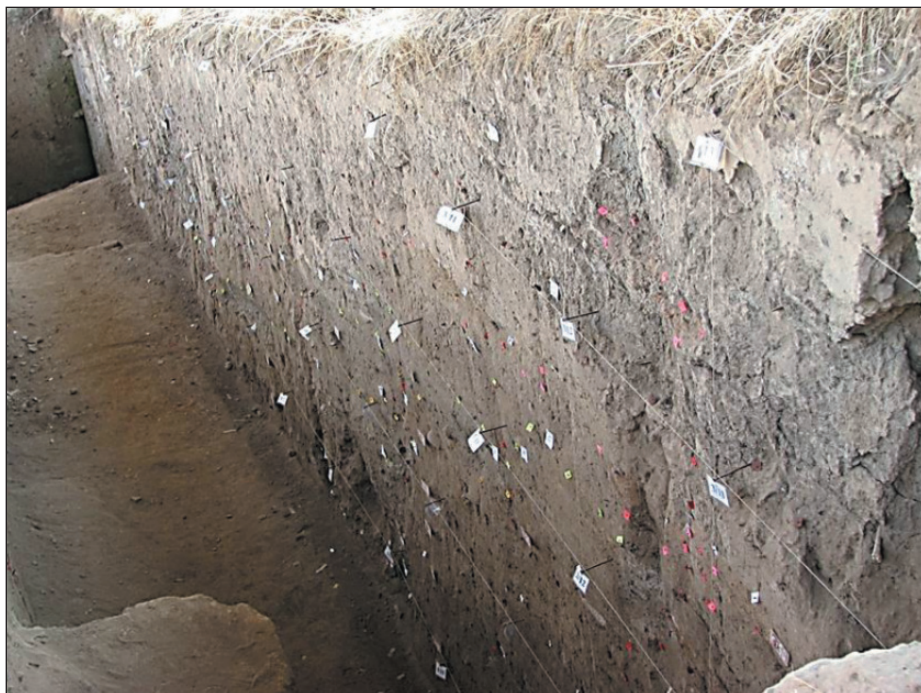
شکل ۴- نمایی از ترانشه حفاری شده در منطقه که فعالیت‌های زمین‌ساخت منطقه به صورت جابه‌جایی لایه‌ها در آن قابل بررسی است.
