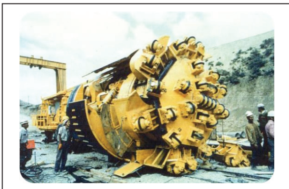
شکل ۴- اولین سری تی‌بی‌ام وارداتی در دهه پنجاه شمسی جهت حفاری تونل کوهرنگ، ساخت شرکت کاواساکی ژاپن.
