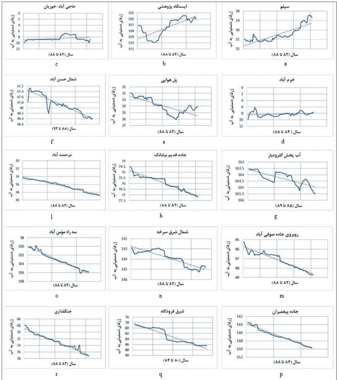
شکل ۴- تغییرات ژرفای سطح آب (متر) در محل هر یک از جاه‌های پیژومتری در بازه زمانی ۱۳۸۲ تا ۱۳۸۸؛ (a) سیلو؛ (b) ایستگاه پژوهشی؛ (c) حاجی آباد- خوربان؛ (d) خرم آباد؛ (e) پل هوایی؛ (f) شمال حسن آباد؛ (g) آب پخش گل رودیار؛ (h) جاده قدیم بیابانک؛ (i) مرحمت آباد؛ (j) روبروی جاده صوفی آباد؛ (k) شمال شرق سرخه؛ (l) سه راه مومن آباد؛ (m) روبروی جاده صوفی آباد؛ (n) شمال شرق سرخه؛ (o) سه راه مومن آباد؛ (p) جاده پیغمبران؛ (q) شرق فرودگاه و (r) جنگلداری (ملایی‌نیا، ۱۳۹۴).
