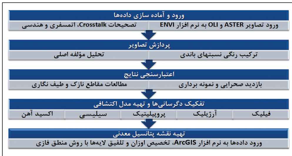
شکل ۲- روند نمای تهیه نقشه پتانسیل معدنی با استفاده از مدل‌سازی اکتشافی کانسارها در منطقه اسفندقه بر اساس داده‌های ماهواره‌ای.
