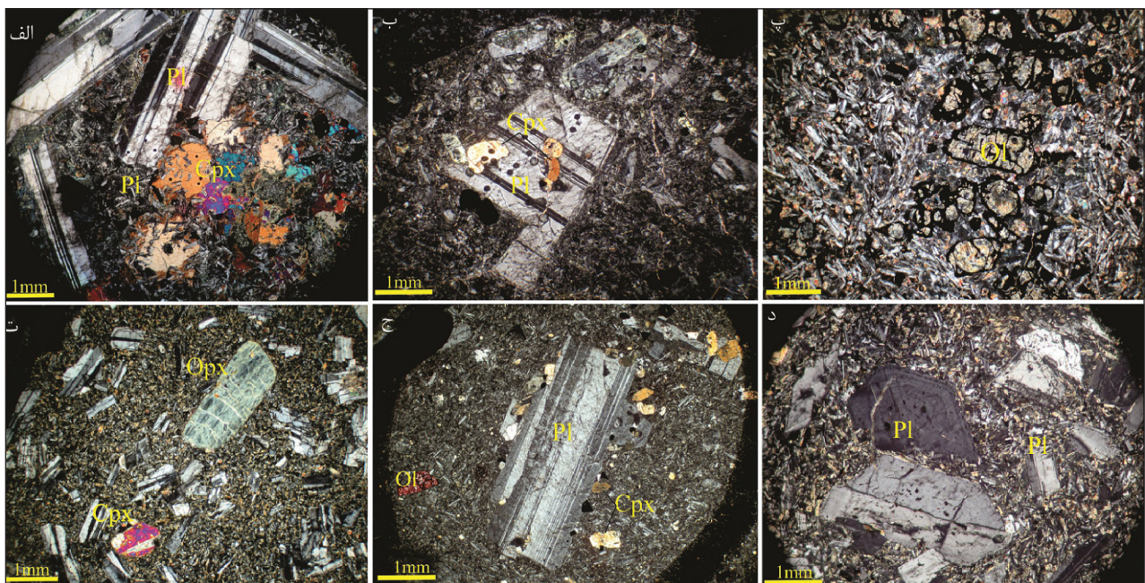
شکل ۳- تصاویر مختلف از مقاطع نازک میکروسکوپی سنگهای آتشفشانی منطقه کهک در شرایط XPL: الف) نمونه بازالتی با درشت‌بلورهای کلینوپیروکسن‌های دارای بافت پوئی‌کلیتیک؛ ب) بافت پوئی‌کلیتیک حاصل از قرار گرفتن کانی‌های کلینوپیروکسن در درشت‌بلور پلاژیوکلاز؛ پ) قالب‌های به‌جا مانده از الیون در یک نمونه سنگ بازالتی؛ ت) قالب‌های کلریتی ارتوپیروکسن در یک نمونه سنگ بازالتی؛ ج) بافت پورفیری در سنگ‌های آندزیت بازالتی؛ د) بافت‌های مختلف پلاژیوکلاز در سنگ‌های آندزیت بازالتی.
