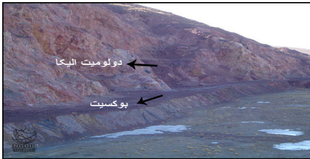
شکل ۴- نمایی از معدن بوکسیت جاجرم، سنگ بستر دولومیتی الیکا به رنگ روشن و بوکسیت به رنگ سرخ دیده می‌شود.
