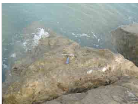
شکل ۹- سنگ آهک متبلور با درز و شکافهای اولیه کم در ناحیه کشندی
