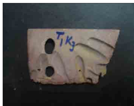
شکل ۴- نفوذ موجودات دریایی به درون سنگ آهک مارنی در ناحیه غرقابی
