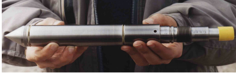
شکل ۵- تصویری از مخروط دستگاه CPTu مورد استفاده در مطالعات پل میانگذر دریاچه ارومیه
