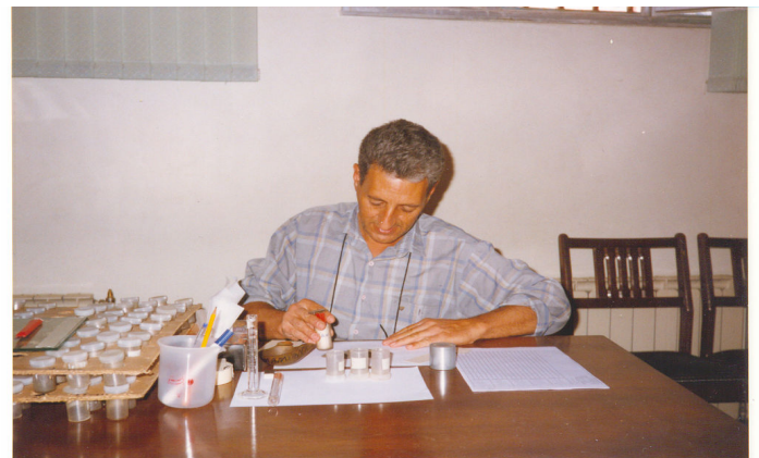
شکل ۷- جدایش بخش سنگین نمونه‌های کانی سنگین با استفاده از
