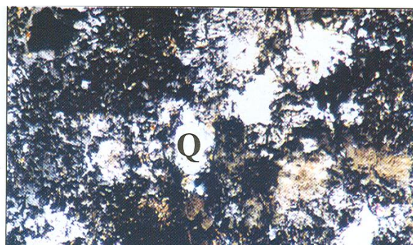
شکل ۵-د) ریولیت اسفرولیتی با مجموعه‌ای از فلدسپار قلیایی و کوارتز ثانوی با دگرسانی سیلیسی و به مقدار کم دگرسانی سریستی (۵۰× نور پلاریزه)
