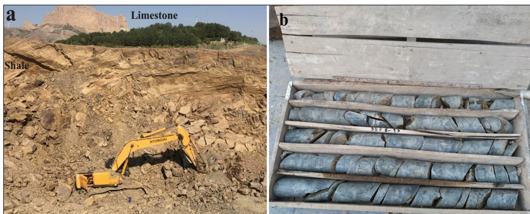
شکل ۳- (a) ریزش سنگ شیل در امتداد درزه در دیواره گود، جنوب شهر اصفهان، (b) نمونه حاصل از گمانه اکتشافی در سنگ بستر در خیابان مسرور. Figure 3- a) Shale rock falling along the joints in the pit wall, south of the Isfahan city (unit A), b) Samples from the exploratory borehole in the bedrock from the Masroor street.
