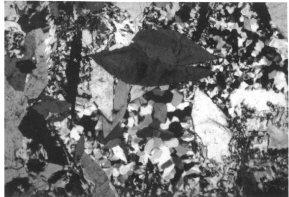
شکل ۱۰- جانشینی ژپس (عدسی شکل) به وسیله سلسیت پر شدگی حفره ها با کوارتز دانه ای و در پایین سمت راست عکس جانشینی سلسیت با (سیلیسی شدن سلسیت) بزرگ نمایی عکس X ۱۰. محل نمونه در پایین ترین بخش میان نیمرخ های E و B.
