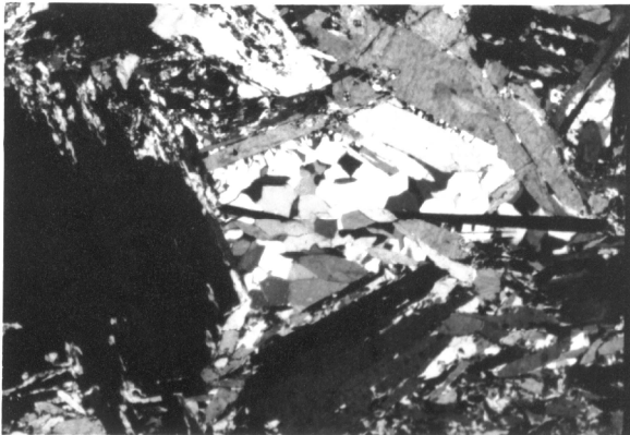
شکل ۱۱- پر شدن حفره ها بافت تخته ای سلسیت به وسیله کوارتز دانه ای، نمونه Af64 با بزرگ نمایی X ۲/۵ از نیمرخ B.
