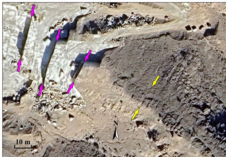
شکل ۷- راستای درزه‌های اصلی موجود در گستره معدن با راستای عمومی ۰۳۲ درجه و شیب زیاد (پیکان‌های زرد رنگ). پله‌های معدن (پیکان‌های صورتی رنگ) به تدریج با جهت درزه‌های تطبیق داده شده‌اند.
