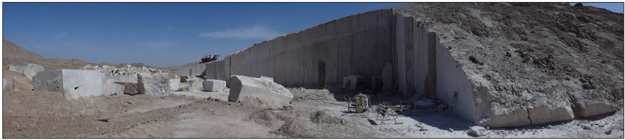
شکل ۸- تهیه چند کوب آزمایشی در یک برش لچکی از معدن.
