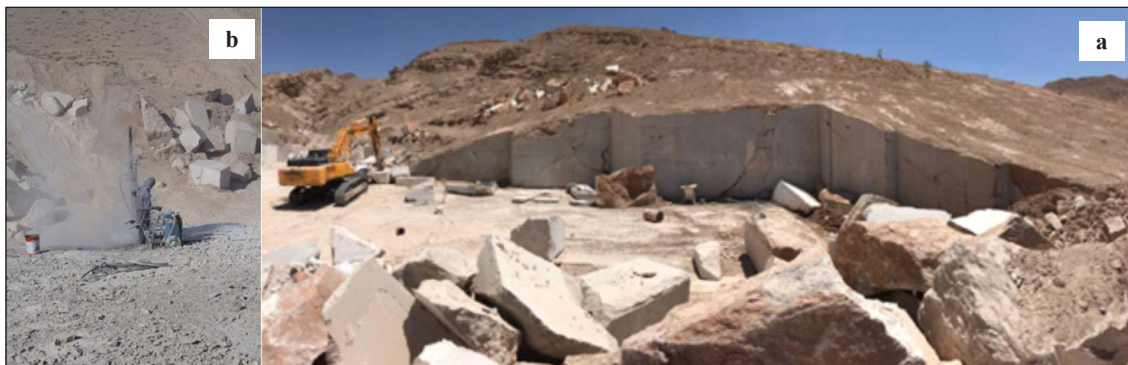
شکل ۵- a) حفر ترانشه به کمک سیم برش الماسه و بیل مکانیکی. b) حفاری اکتشافی عمودی در سنگ معدن با دریل واگن (دستگاه راسول).
