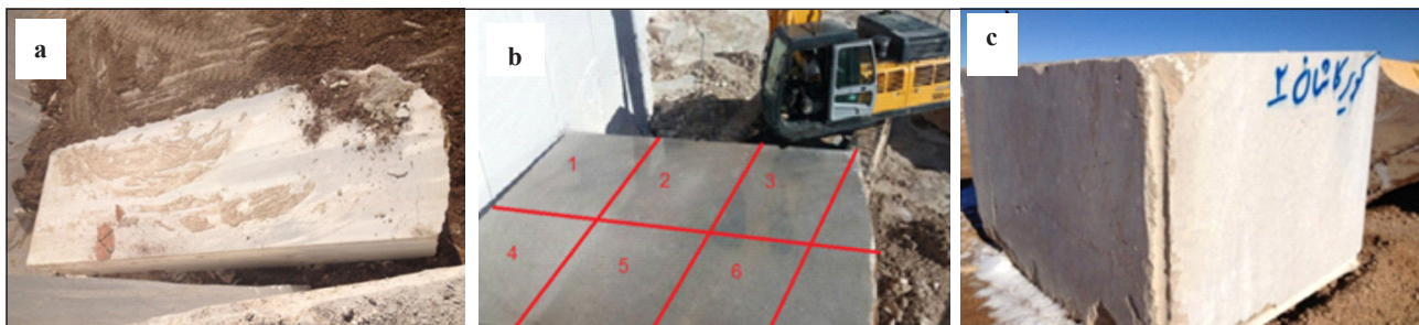
شکل ۱۳- a تا c به ترتیب مرحله‌های روتین خواباندن بلوک، طراحی قواره‌ها و تبدیل بلوک به قواره را نشان می‌دهند.
