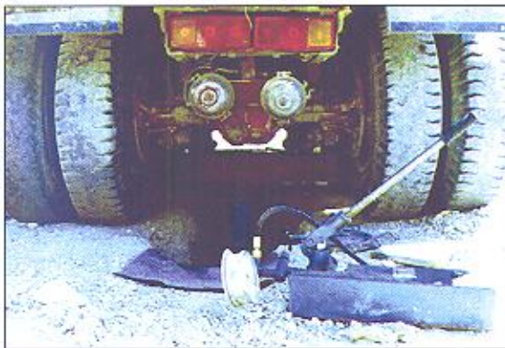
نگاره ۵- تصویری از تامین نیروی عکس العمل بازگذاری صفحه ای توسط کامیون
