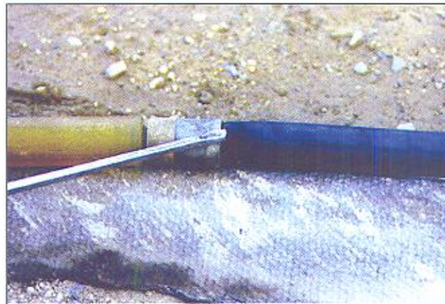
نگاره ۴- تصویری از پاره شدن پوسته لاستیکی از بخش فوقانی سنود
