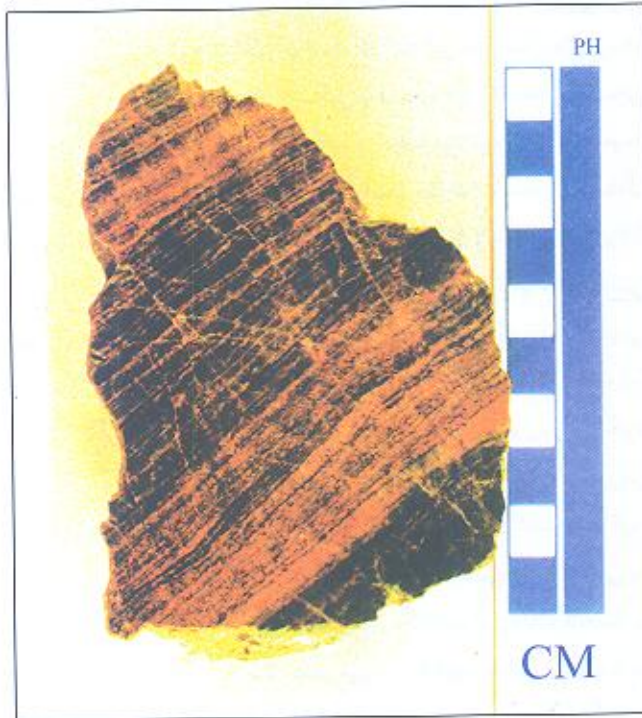
تصویر ۱۳- نمونه دستی از رخساره دولواسپاریت تیغه دار در بخش باختری میلاکوه، که از تناوب تیغه های خاکستری تیره و تیغه های قرمز تا صورتی رنگ تیغه های آلگی (algal lamination) تشکیل شده است.
