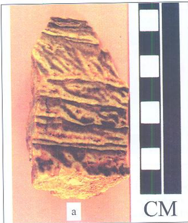
تصویر ۷- a: نمونه دستی از بافت DCR در رخساره دولومیکرواسپاریت- دولواسپاریت در معدن منصوری که در آن نسل های سه گانه سخت شدگی ی قابل تفکیک است.
