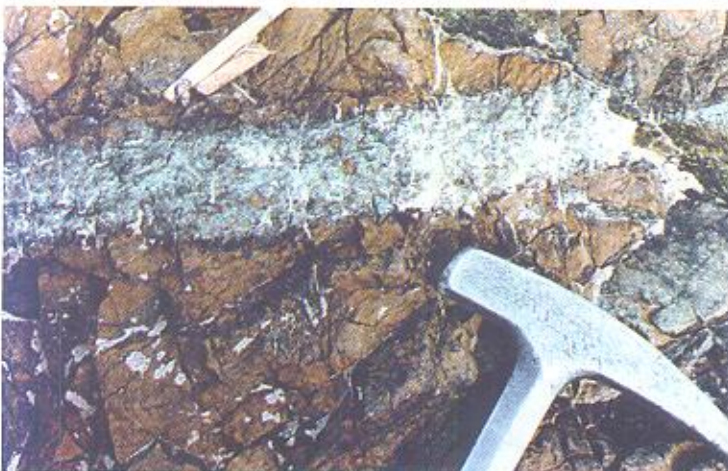
عکس ۴ - وجود دو نوع کروم اسپینل در هارزیورژیت ها. یکی از آنها (sp1) به صورت بلورهای درشت و مسطح و دیگری (sp2) به صورت بلورهای ریز فقط در ارتوپیروکسن بدون تغییر شکل دیده می شود.
