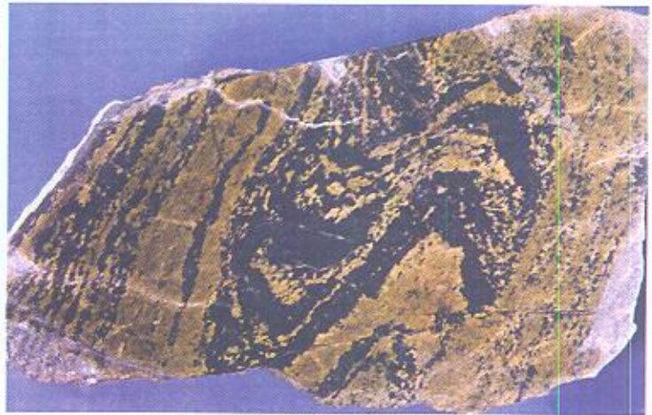
عکس ۳ - چین خوردگی های درون لایه ای بی ریشه در کرومیتیت های معدن دیبای قدیم ضخامت لایه های کرومیت در محور چین ها افزایش یافته است.
