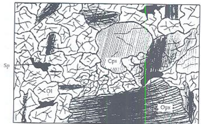
شکل ۸- شکل نشانگر یافت لرزولیت به همراه بلورهای درشت ارتوپیروکسن، کلینوپیروکسن و الیون‌های دانه ریز و اسپینل‌های بین دانه‌ای است.
