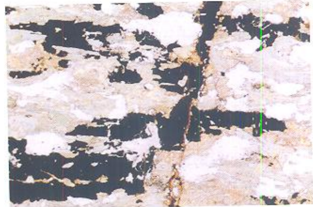
شکل ۱۱ - رگچه سولفیدی جوان که لایه بندی اولیه (لایه های افقی) و کانی های اکتینولیت را قطع کرده است. نور PPI، بزرگنمایی X ۴۰
