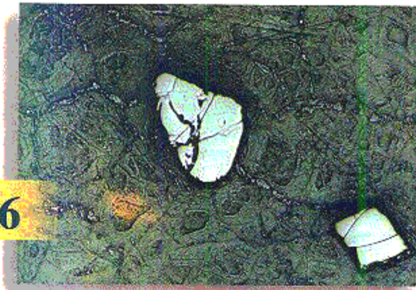
شکل ۶ - بافت مشبک همراه با بلورهای پراکنده کرومیت - بلورهای پراکنده کرومیت سیلیکات‌ها (بیشتر اولیون‌های سرپانتینی شده) را احاطه کرده‌اند. نور انعکاسی - طول تصویر ۱/۵ میلی‌متر.
