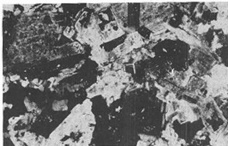
عکس ۱- بلورهای پلاژیوکلاز به صورت غیر هم بعد (inequigranular) در حالی که به کانی‌های رسی دگرسان شده‌اند، دیده می‌شوند.
