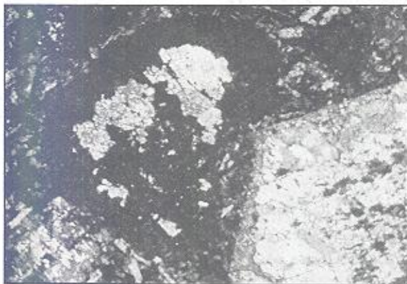
عکس ۳- پلاژیوکلاز تجزیه شده و حفره‌های حاوی اپیدوت و کربنات (در مرکز) و کلریت (در حاشیه تیره‌رنگ) (متابازیتی از منطقه ساوه).
